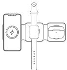
产品名称:三合一无线充电器 材 质:ABS+硅胶 寸: 247\*74.5\*7.5MM □: USB-C 入: 9V-2A,12V-2A 手机输出: 5W/7.5W/10W/15W 手表输出: 2.5W
